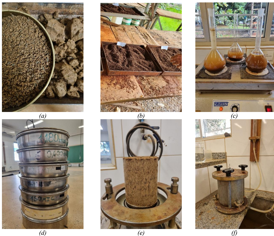
Figura 2: Preparação do LETA para ensaios de caracterização (a), secagem do material para atingir a umidade higroscópica (b), ensaio de determinação da massa específica (c), peneiramento fino para ensaio de análise granulométrica (d), ensaio de compactação (e) e determinação do coeficiente de permeabilidade (f).
