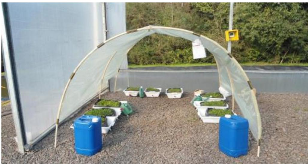
Figura 1. Estrutura de arco para evitar o contato dos aerossóis com os protótipos de bancada (PBs) – antes do início dos experimentos.
