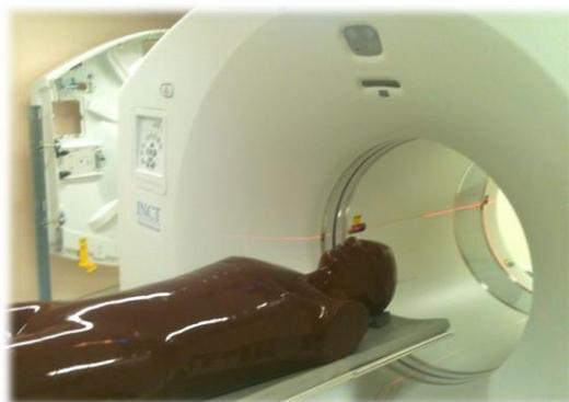
Figura 2: Simulador Alderson Randon® submetido ao mesmo protocolo de aquisição de imagens de PET/CT para diagnóstico de CCL.
